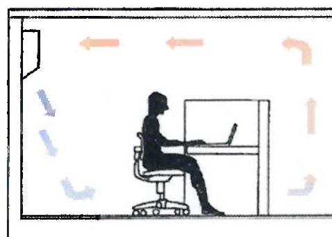
Figura 2-4 - Fluxo de ar no interior da câmara de testes
